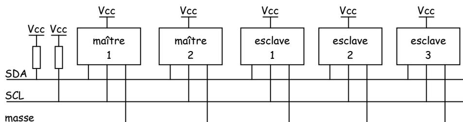
Au repos, c'est à dire lorsque aucun circuit n'émet, les signaux **SDA** et **SCL** sont au niveau logique **haut**.
