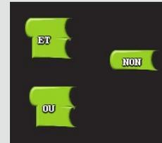
Module d'action, permettant de faire du calcul logique, seulement sur des valeurs numériques. Le bloc est la réponse du calcul logique de ses entrées, soit un «0» ou un «1» logique.
