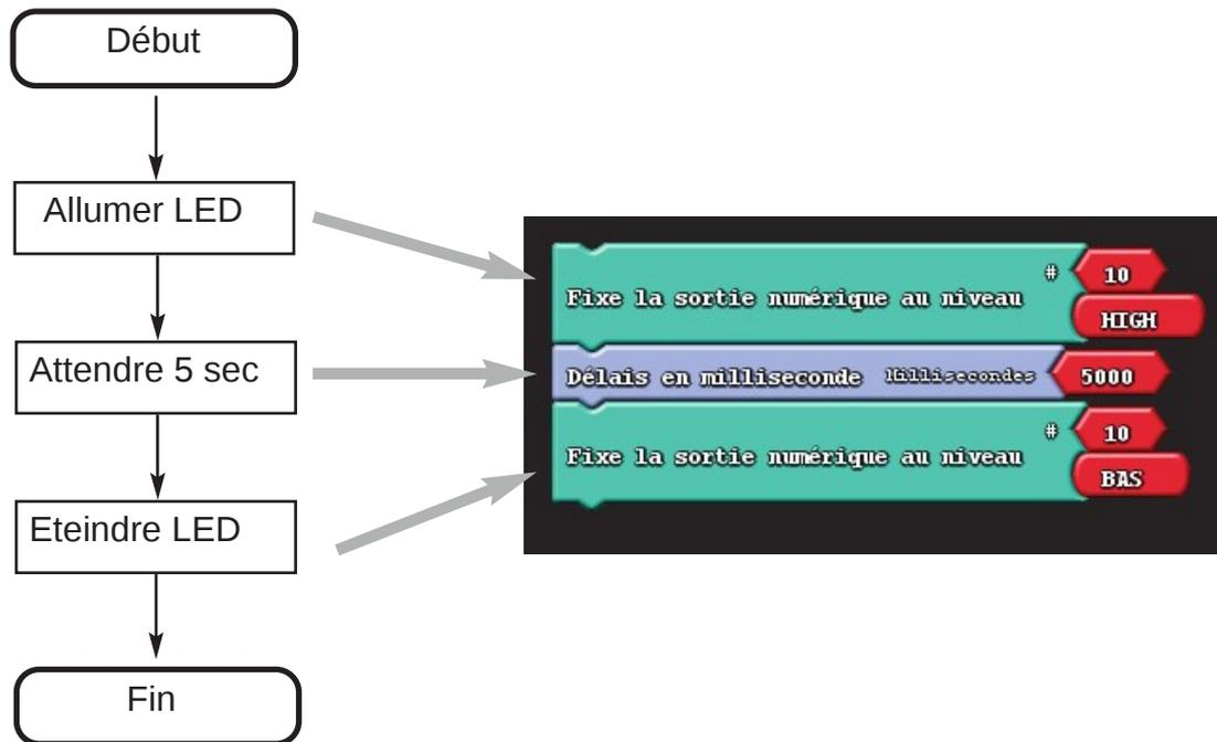
Dans ce cas là, nous voulions allumer une LED 5 secondes puis l'éteindre. La solution de codage sur Ardublock proposée ci-dessous est la suivante :
