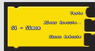
Module de conditions, le programme regarde si la condition insérée dans «Teste» est vraie, si oui il exécute les actions dans «Alors exécute», sinon celles dans «Sinon exécute»
